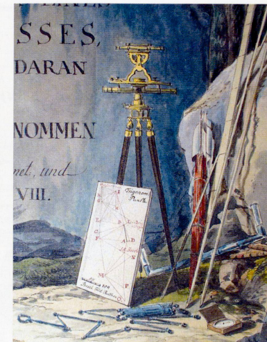
Abb. 6: Ausrüstung für eine Kartierung des Birslaufs 1798: Theodolit, Messkette, Messlatte, Bussole usw. (Staatsarchiv Basel-Stadt, Planarchiv T, 148).
