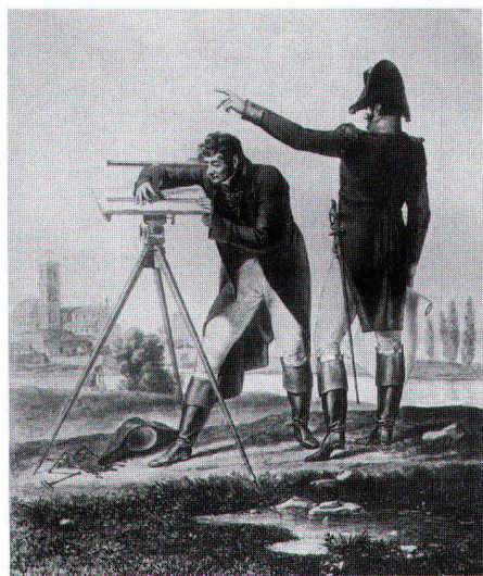
Abb. 5: Französischer «Ingénieur Géographe Militaire» bei topographischen Aufnahmen mit dem Messtisch (Aus: H. Berthaut: Les Ingénieurs Géographes Militaires 1624–1831. Paris 1902.
