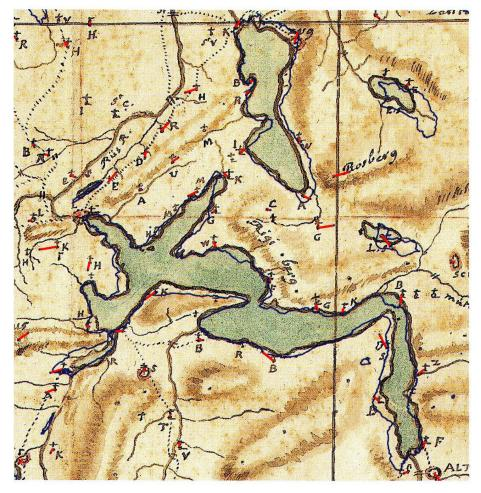
Abb. 9: Ausschnitt aus der Manuskriptkarte von Franz Ludwig Pfyffer, transformiert in die Landeskoordinaten (ca. 33 x 33 km). In blau sind die heutigen Seeufer und in rot die Abweichungen an identischen Punkten dargestellt. Im Gegensatz zu allen anderen untersuchten Quellen ist diese Karte fast genau nach Norden ausgerichtet (vgl. dazu Abb. 6 und Tab. 1).
