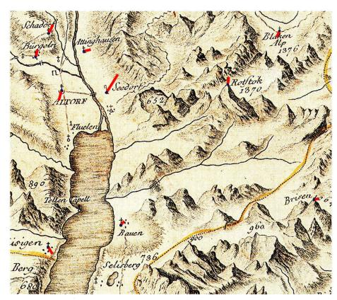
Abb. 8: Ausschnitt im Originalmassstab aus der *Carte en Perspective du Nord au Midi d'après le Plan et les mesures du Général Pfyffer* von Jakob Joseph Clausner. Die roten Linien stellen die Abweichungen an den identischen Punkten dar.
