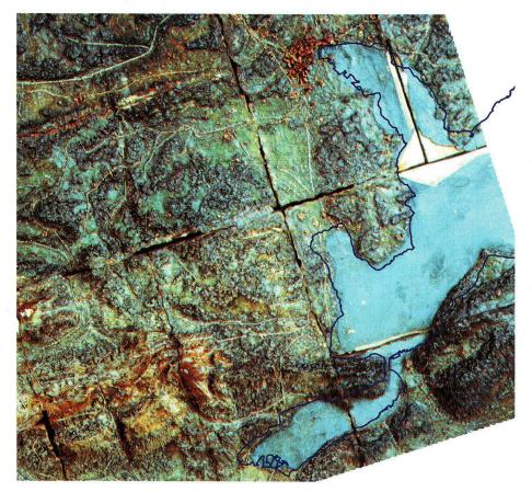
Abb. 6: Das Relief der Urschweiz in den Landeskoordinaten, überlagert mit dem heutigen Seeufer (Ausschnitt ca. 13 x 13 km). Man sieht die gute Übereinstimmung von Pfyffers Vermessung und Modellierung mit der Realität. Der Reliefteil weicht um etwa 17 Grad entgegen dem Uhrzeigersinn von der Nordrichtung ab.
