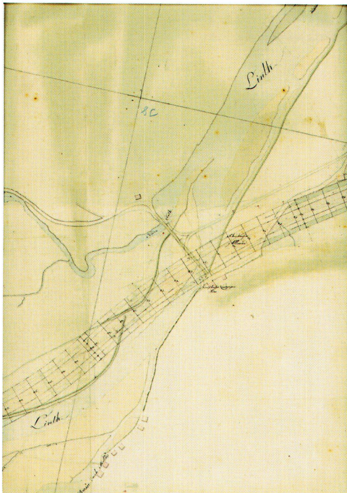
Abb. 5: Ausschnitt Mollis/Näfels aus dem Plan des projektierten Kanals von Näfels bis ins Gösli. Von Hans Jakob Frey aus dem Jahr 1807. Massstab 1:2000, 240 x 85 cm (LIAR F 2.2.1).
