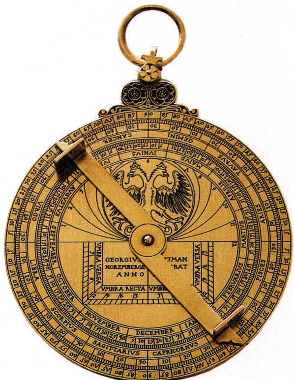
Abb. 6: Hartmann-Astrolabium, Nürnberg 1531. Rückseite mit Eklipktik- und Kalenderkreis. Im Zentrum das Schattenquadrat (unten) und das Diagramm der ungleichen Stunden (oben). Über der Rückseite dreht sich die Alhidade mit Diopter. Messing-Nachbau, Durchmesser 100 mm.
