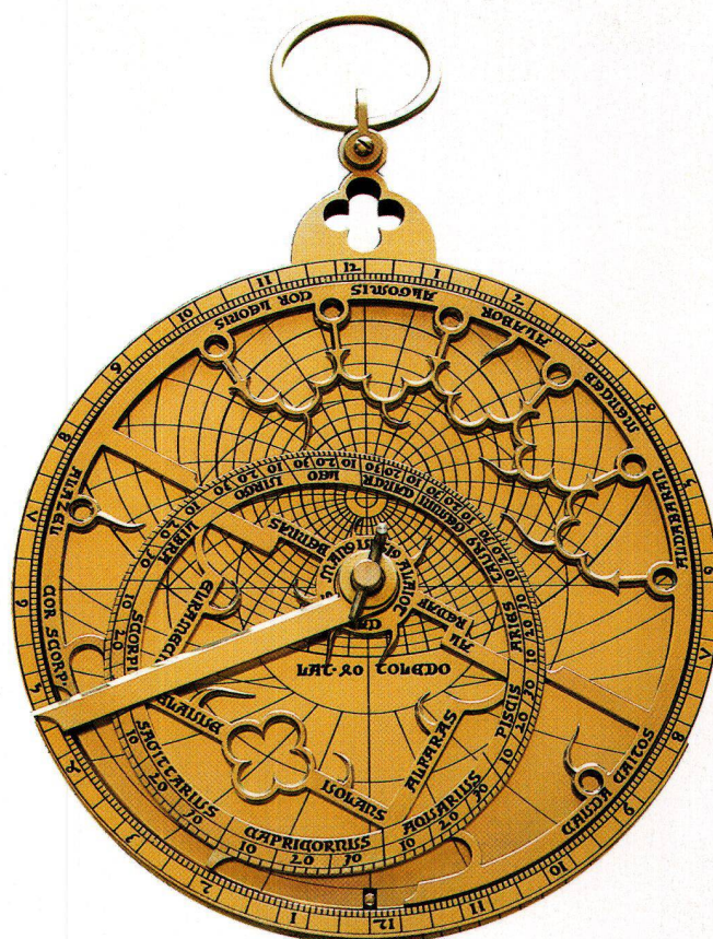
Abb. 2: Spanisch-gotisches Astrolabium. 14. Jahrhundert, Vorderseite. Messing-Nachbau, Durchmesser 120 mm.
