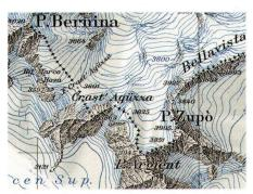
Abb. 3: In der Erstausgabe von Blatt 268 Julierpass der Landeskarte 1:50000 erschien 1950 erstmals die Kote 3995.7 des 1931 bestimmten Triangulationspunktes 4. Ordnung.
