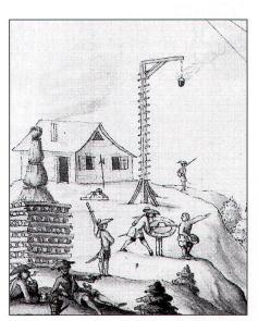
Abb. 11: Ausrüstung einer Hochwacht: Rechts auf einem Pflock die Scheibe mit den Visierlinien und dem drehbaren «Absichtsdünchel» zur genauen Lokalisierung des Feuers. Ausschnitt aus dem Hochwachtenplan; ganz abgebildet in: *Cartographica Helvetica* 13 (1996), S. 24 (Zürich, Handschriften-Sammlung Zentralbibliothek).
