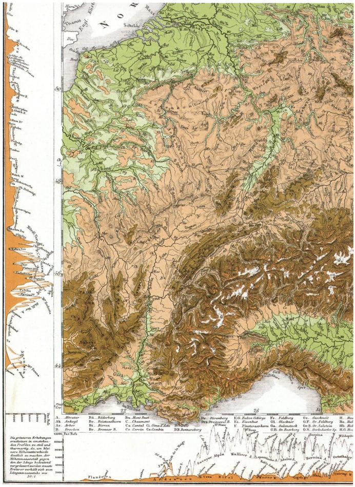
Abb. 2: Geländedarstellung im berühmten «Stieler» aus der *Fluss und Bergkarte von Deutschland und den anliegenden Ländern:* Gebirgsschraffen und hypsometrische Farbstufen in Pariser Fuss sowie Profile in dreissigfacher Überhöhung. Die Gebirgszüge sind ungenau und zeigen
