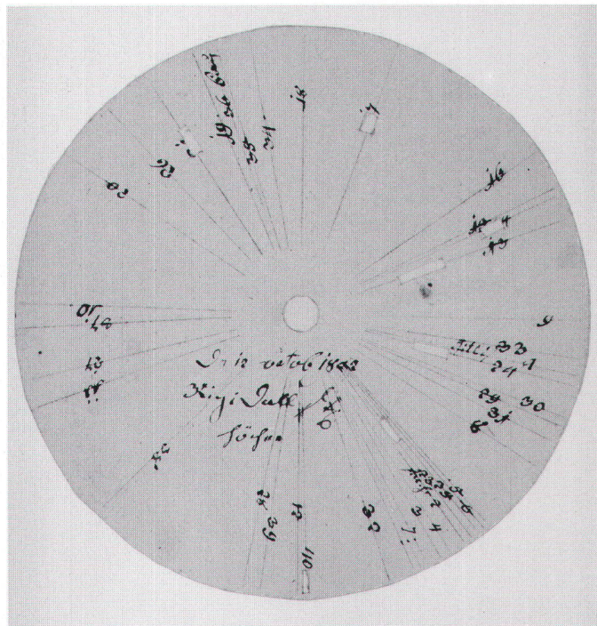
Abb. 7: Mess-Scheibe von Joachim Eugen Müller, wie sie für die graphische Triangulation verwendet wurde. Abb. leicht verkleinert (Wissenschaftshistorische Sammlungen der ETH Zürich, Hs. 1060:470/1).
