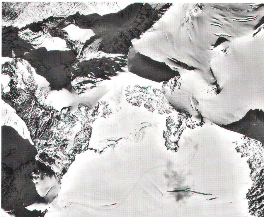
Abb. 13: Dieses Luftbild wurde bei der Höhenbestimmung in der Gesamtnachführung 1993 mitverwendet: Aufnahme aus 6400 m ü.M. (Photothek L+T, Aufnahme 4983 aus der Fluglinie 565 der Landkarte 1:50 000 Blatt 264 Jungfrau vom 20.9.1993, 13.55 Uhr aus 6400 m ü.M. mit einer RC-30-Kamera von Leica).
