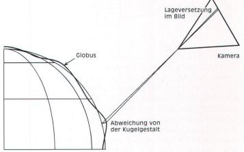
Abb. 4: Lageversetzung im Bild auf Grund einer Abweichung von der Kugelgestalt.
