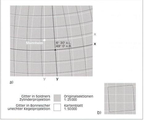
Abb. 2: Prinzipskizzen. Originalsektionen 1:25 000 und Kartenblätter 1:50 000 besitzen unterschiedliche Fundamentalpunkte. Die Gitterlinien werden bei der Betrachtung grossräumiger Gebiete gekrümmt abgebildet (a). Neun Originalsektionen ergeben ein Kartenblatt. Die gekrümmten Blattgrenzen können durch Geraden ersetzt werden (b).
