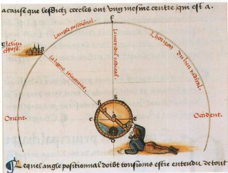
Abb. 4: Oronce Fine: Compositum et usaige d'un singulier méthéoroscope géographique, 1543. Das Meteoroskop benützte man zur Bestimmung von geographischen Koordinaten. Es war eine Neuerfindung von Fines Zeitgenossen, ein mit einer Bussole ergänztes Astrolab (BNF, Ms. fr. 1337, fol. 19).
