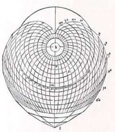
Abb. 1: Johannes Werner, Konstruktion der herzförmigen Projektionsart. Aus: Libellus de quatuor terrarum orbis in plano figurationibus. Ingolstadt, 1533. Der Äquator und die Breitenkreise sind als Kreisbogen dargestellt, die den Nordpol (k) als Zentrum haben (BNF, Rés. Ge FF 8345).
