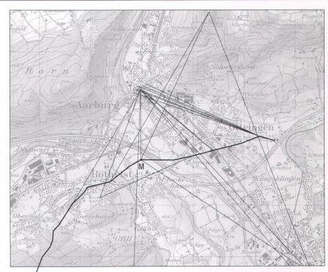
Abb. 12. / Die Basis von Aarburg, von Osten nach Süd-Westen gemessen zwischen dem 13. und dem 15. September 1756. Auf dem Meridianpunkt M bei Rothrist (Koordinaten 634975/239875) wurde vermutlich der Meridian gemäss Abb. 10 bestimmt. Ausschnitt aus der Landeskarte 1:50 000, Blatt 224 Olten.
