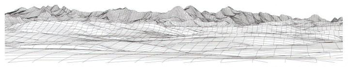
Abb. 17. Derselbe Ausschnitt, rechnerisch erstellt auf der Grundlage des digitalen Höhenmodells DHM25/50 des Bundesamtes für Landestopographie. Es ist nur eine Maschenweite von 50 m dargestellt. Der Vergleich mit Abb. 16 zeigt, dass Micheli die Landschaftsformen im Grossen und Ganzen
