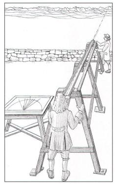
Abb. 5. Rekonstruktion von Michelis Messinstrumenten: Rechts die 24 Fuss lange Dachrinne zur Bestimmung der Höhendifferenzen gegenüber Aarburg, links der Messtisch mit einer Visiervorrichtung bestehend aus einer festen und einer beweglichen Bleinadel, mit welcher die verschiedenen Alpengipfel anvisiert und ihr seitlicher Abstand an einem Kreis vom 14–15 Zoll Radius abgelesen werden konnte. Zeichnung von Alfred Oberli, Wabern 1994.
