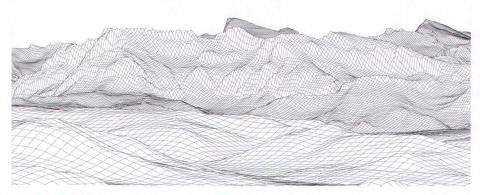
Abb. 13. Der Einfluss von Erdkrümmung und Refraktion anhand eines Blicks von Aarburg Richtung Pilatus. Wäre die Erde eben und gäbe es keine Refraktion, so würde sich der Titlis (Bildmitte) deutlich über das Tomlishorn erheben.
