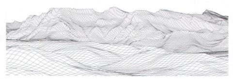
Abb. 15. Michelis Berechnungsmodell mit Erdkrümmung, aber ohne Refraktion: Die Erdkrümmung lässt den Titlis vollständig hinter dem Tomlishorn verschwinden, da die anhebende Wirkung der Refraktion fehlt (Berechnungen auf der Grundlage des digitalen Höhenmodells DHM25 des Bundesamtes für Landestopographie, Zylinderprojektion mit einem Radius von 1200 mm, gerechnet mit dem Programmsystem SCOP der Technischen Universität Wien).
