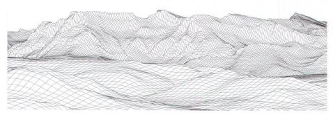
Abb. 14. Gleiche Blickrichtung wie in Abb. 13, aber mit Berücksichtigung von Erkrümmung und Refraktion nach den heute gültigen Grundsätzen: Der Titlis schaut noch knapp rechts und links des Tomlisherns hervor
