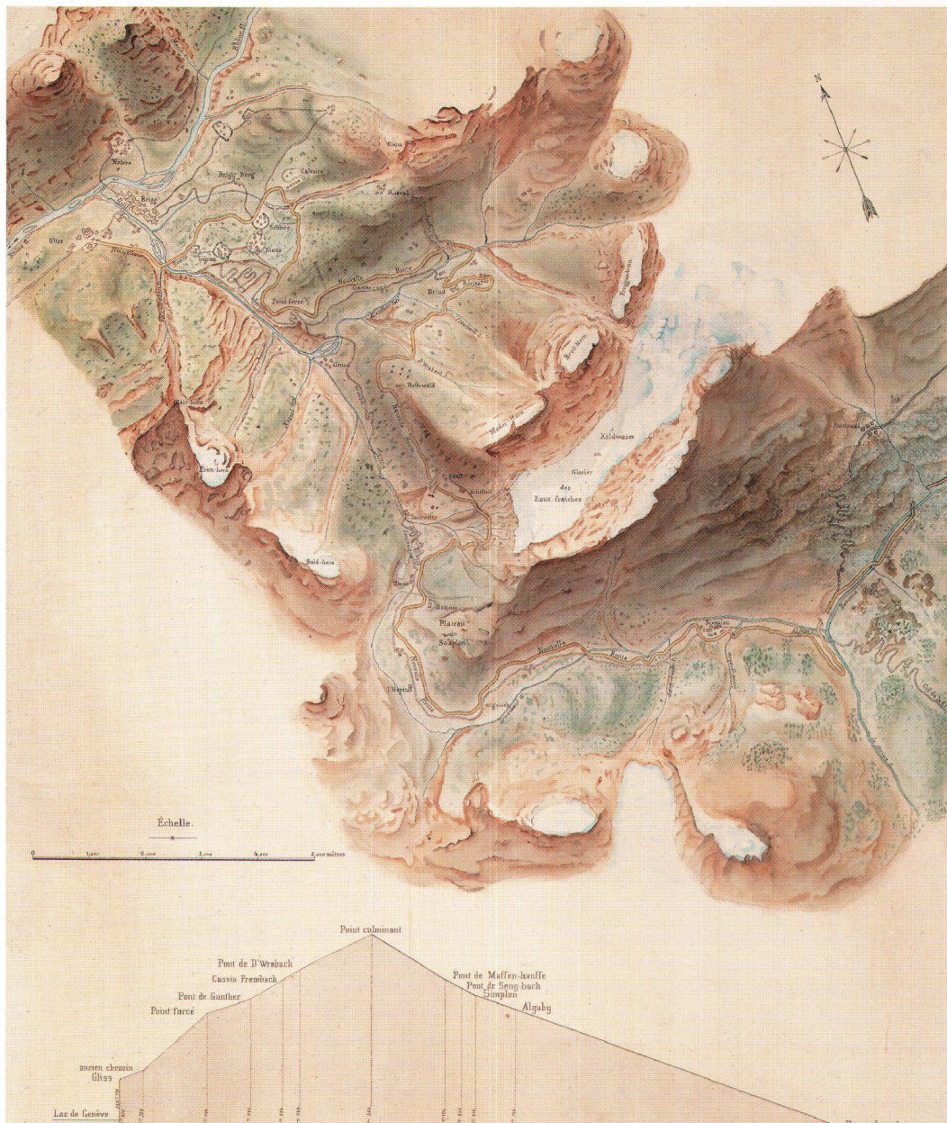
Abb. rechts: Anonym. Plan und Steigung der neuen Simplonstrasse. Feder und Tusche, aquarelliert, nach einem Original des Archivs des Ponts et Chaussées in Paris, um 1805. (Staatsarchiv Sion).
