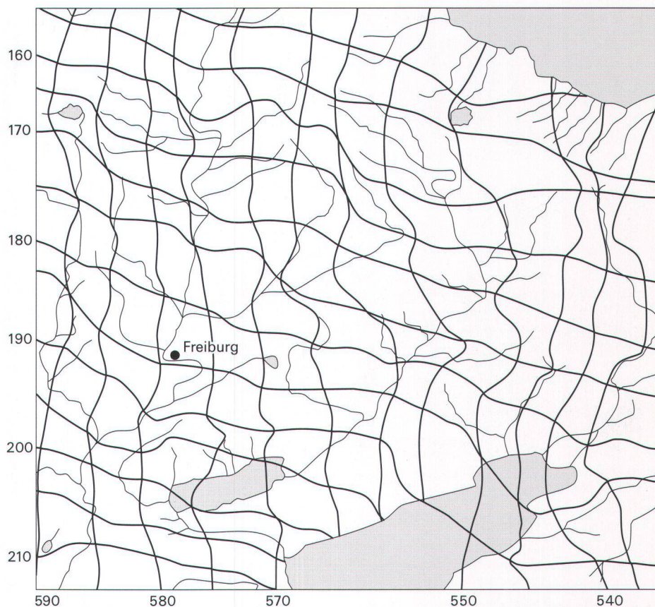
Abb. 9. Verzerrungsgitter der Freiburger Kantonskarte von Wilhelm Techtermann, 1578. Maschenweite 5 km. (Entwurf: H.U. Feldmann).
