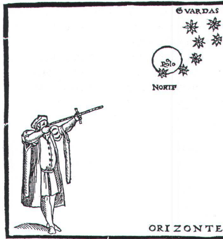
Abb. 3. Bestimmung der geographischen Breite mittels Jakobsstab und Polarstern.
