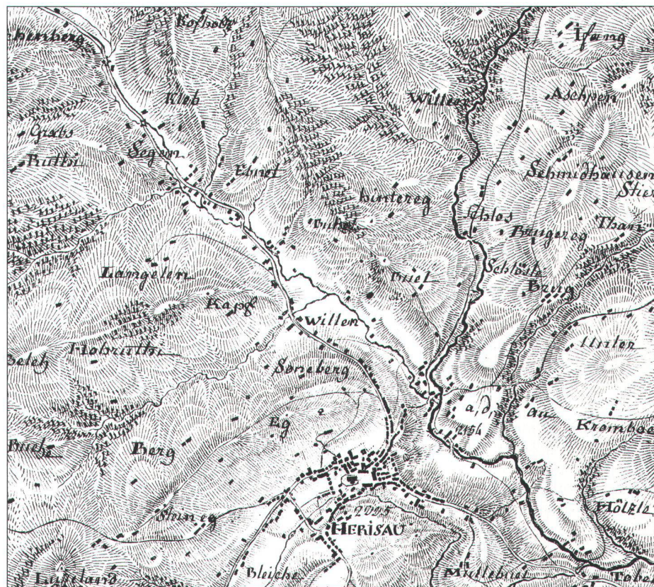
Abb. 15. Ausschnitt aus einem Aufnahmeblatt von Johann Ludwig Mertz (Vater), das deutlich wiedergibt, dass die Geländedarstellung ohne Höhenkurven erfolgte. (Staatsarchiv des Kantons Appenzell-Ausserrhodod, Herisau).
