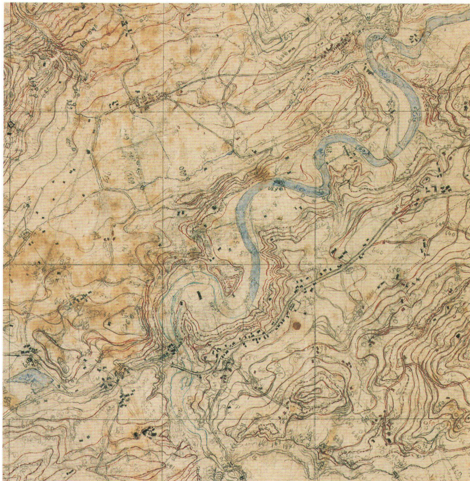
Abb. 7. Ausschnitt aus dem Aufnahmeblatt (Brouillon) mit Steinach und Goldach, in Höhenkurvenmanier. (L+T, Kartenarchiv).
