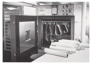
Abb. 14: Klimaschrank mit aufgehängten Karten vor dem Befeuchten.
