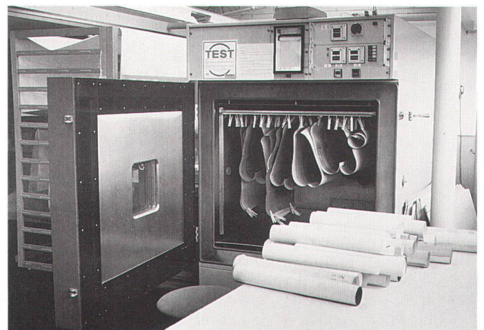
Abb. 14: Klimaschrank mit aufgehängten Karten vor dem Befeuchten.
