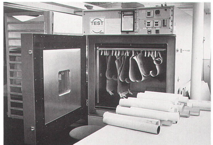
Abb. 14: Klimaschrank mit aufgehängten Karten vor dem Befeuchten.
