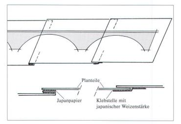
Abb. 6: Schema der Leporello-Technik (Skizze Jürg Stebler).
