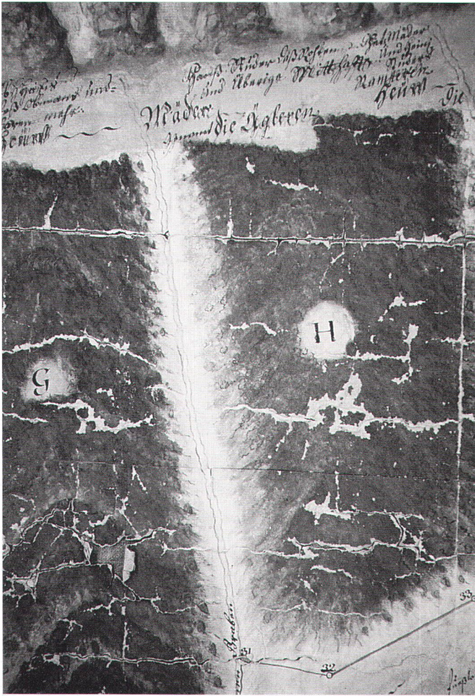
Abb. 3 Abscheuerung der Farbe, Bruchstellen und Risse in Längs- und Querrichtung des Papiers.
