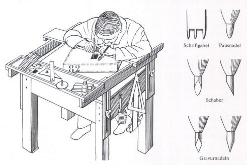
Abb. 8: Der Arbeitstisch des Lithographen und Steingraveurs sowie deren Gravurwerkzeuge (Zeichnung A. Oberli).
