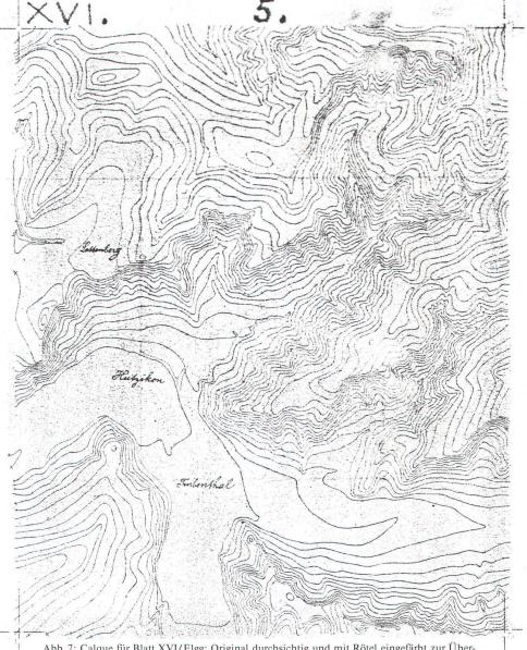
Abb. 7: Calque für Blatt XVI/Elgg; Original durchsichtig und mit Rötel eingefärbt zur Übertragung der Höhenkurven auf den Lithographiestein. (Staatsarchiv des Kantons Zürich).
