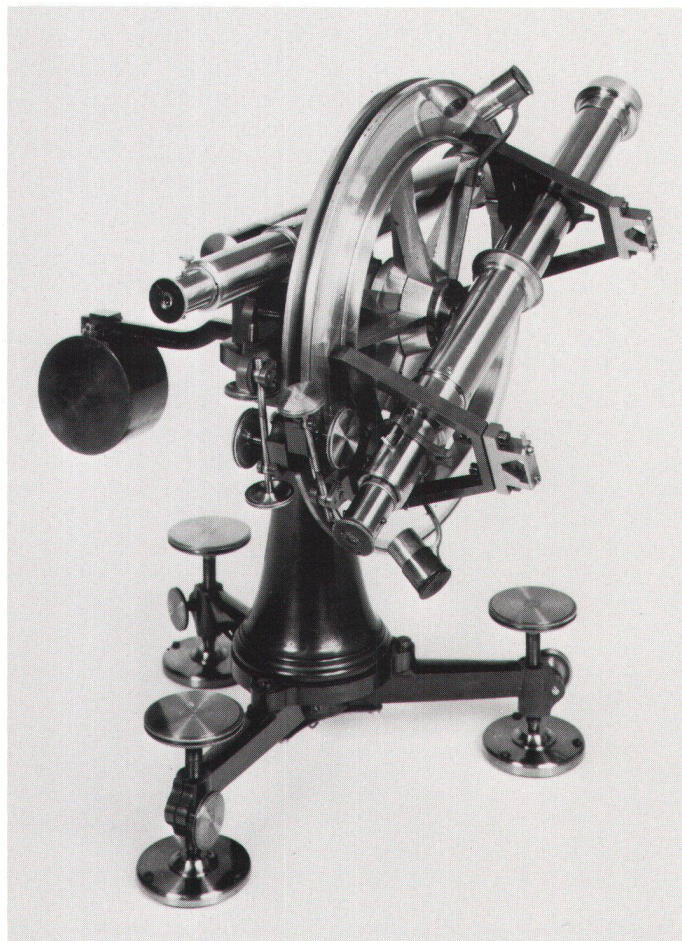
Abb. 7. Achtezölliger Multiplikations-Theodolit von Reichenbach-Utzschneider, München (1819). Links für Vertikalwinkel, rechts für Horizontalwinkel eingerichtet. (Bundesamt für Landestopographie, Wabern).
