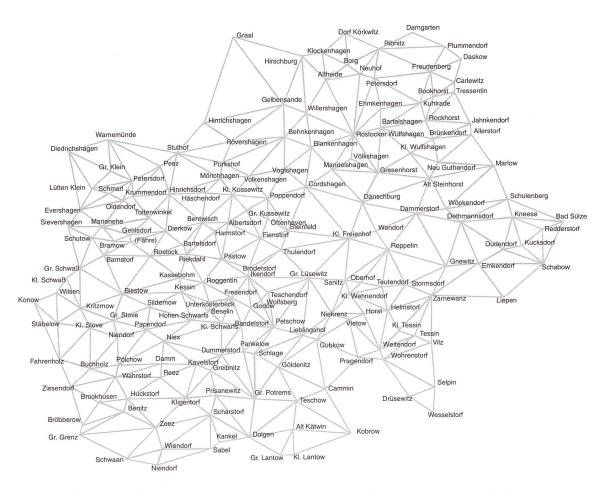
Abb. 7 Dreiecksnetz in der aktuellen Topographischen Karte (Maßstab 1 : 100 000).
