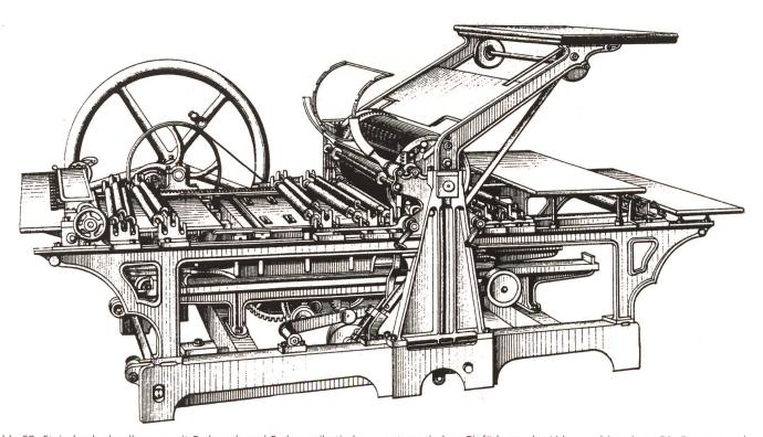
Abb. 69: Steindruckschnellpresse mit Farbwerk und Farbverreibetisch zur automatischen Einfärbung des Lithographiesteines. Die Bogen wurden von Hand an- und abgelegt. Der Antrieb der Maschine erfolgte hier manuell über ein Schwungrad.
