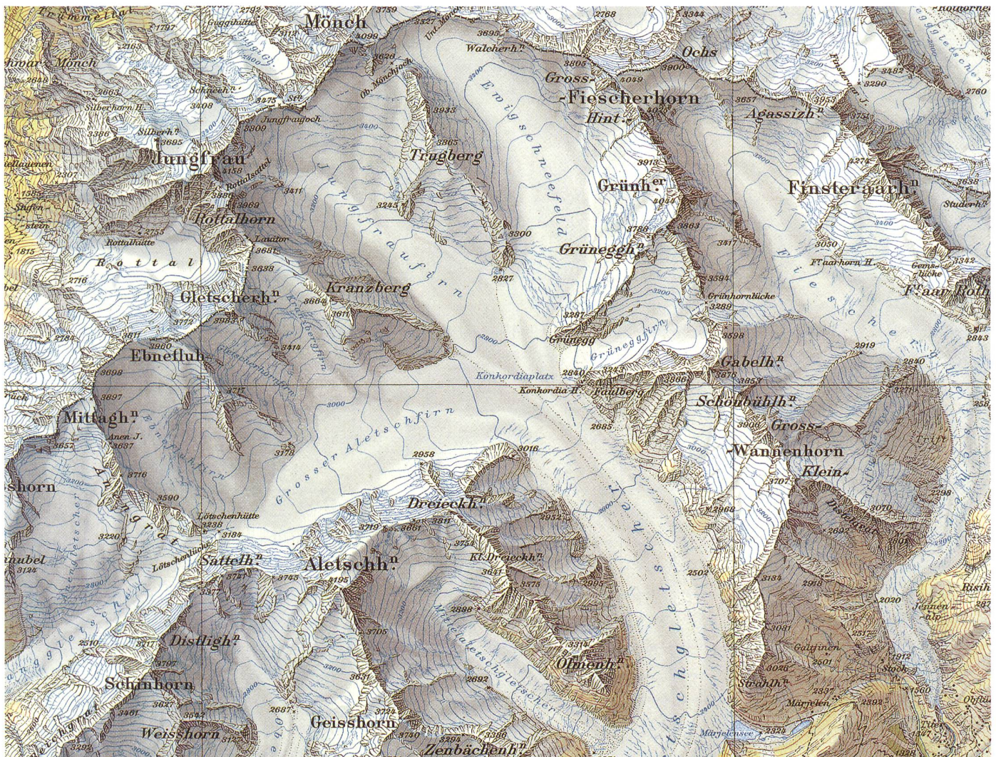
Abb. 64: Neue Landeskarte 1: 100 000, Probedruck 1944. Ausschnitt aus Blatt 84 N Oberwallis W. Für die Geländedarstellung werden neben den Höhenkurven und Felsen zwei Relieftöne und ein gelber Lichtton verwendet (Kartensammlung L+T).
