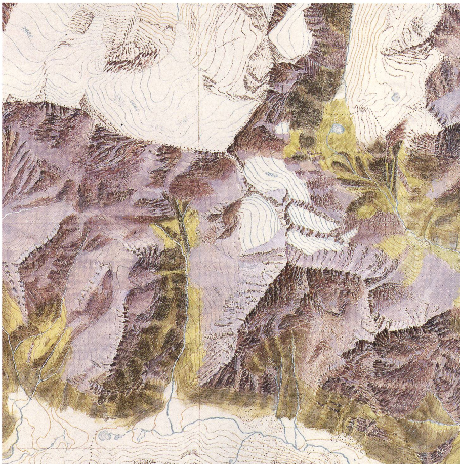
Abb. 54: Oberengadin. Originalzeichnung von Hermann Kümmerly, ca. 1895. Mit zunehmender Routine der Lithographen wurden die Vorlagen nur noch auf den Schattenseiten vorgezeichnet (Archiv K+F).
