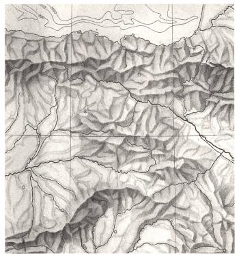
Abb. 42: Pyrenäen-Halbinsel 1:4000000. Ausschnitt aus der einfarbigen Reliefschattierung von Eduard Imhof und Mitarbeiter. Diese Bleistiftzeichnung diente dem Schraffenstecher als Vorlage. Die Schraffen für die Karten im Schweizerischen Mittelschulatlas wurden zum grossen Teil von Oswald Winkel in Leipzig gestochen (Archiv Viola Imhof).
