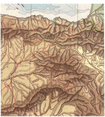
Abb. 43: Die endgültige Reliefkarte mit Schraffen und farbigen Höhenstufen, Sonderdruck ohne Schrift. Schweizerischer Mittelschulatlas, Auflagen 1932 bis 1958 (Archiv Viola Imhof).
