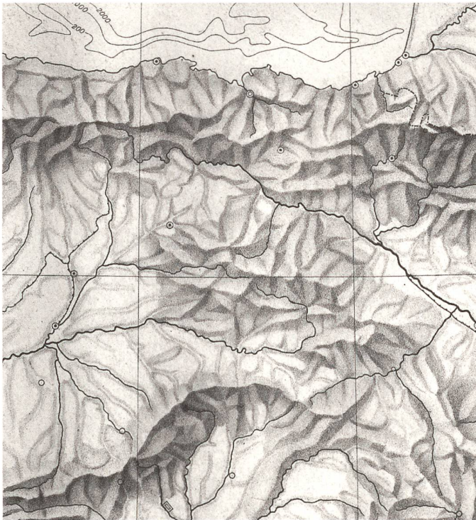
Abb. 42: Pyrenäen-Halbinsel 1: 4 000 000. Ausschnitt aus der einfarbigen Reliefschattierung von Eduard Imhof und Mitarbeiter. Diese Bleistiftzeichnung diente dem Schraffenstecher als Vorlage. Die Schraffen für die Karten im Schweizerischen Mittelschulatlas wurden zum grossen Teil von Oswald Winkel in Leipzig gestochen (Archiv Viola Imhof).
