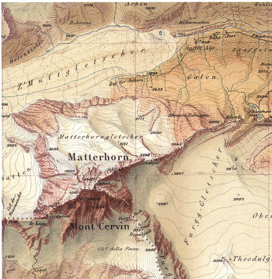
Abb. 35: Die gleiche Karte mit allen Druckfarben. Steingravur von Rudolf Leuzinger, Lithographie durch Gebrüder Kümmerly, Bern.
