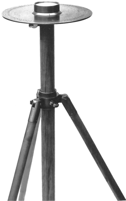
D: Die Mess-Schyben mit aufgesetzter Bussole.
