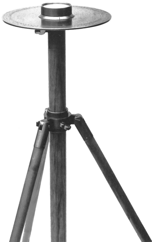
D: Die Mess-Schyben mit aufgesetzter Bussolle.
