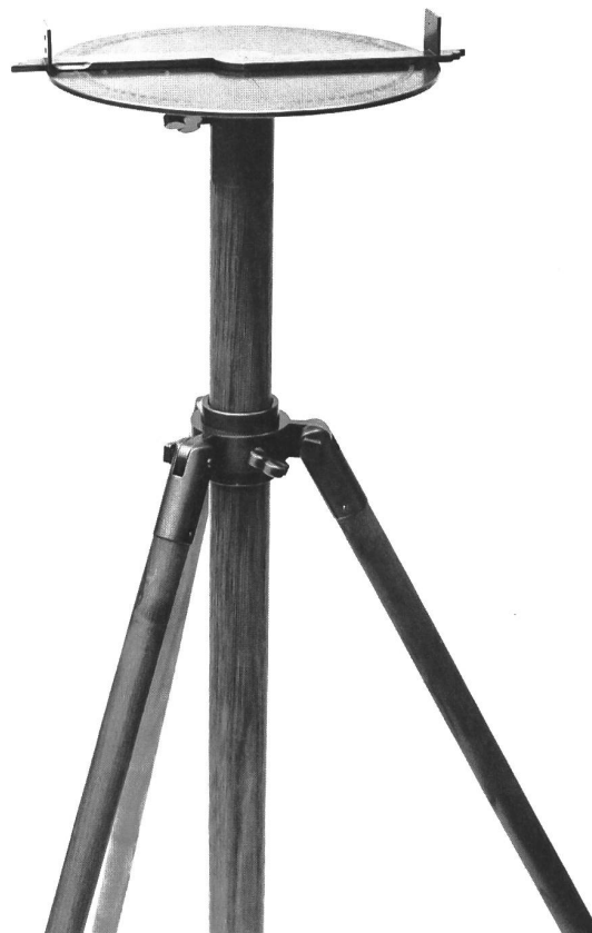
F: Nach dem Entfernen der Bussolle ist die horizontierte und orientierte Mess-Schyben mit aufgesetzter Alhidade für Vermessungsarbeiten einsatzbereit.
