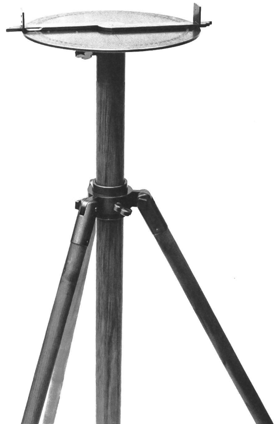
F: Nach dem Entfernen der Bussole ist die horizontierte und orientierte Mess-Schyben mit aufgesetzter Alhidade für Vermessungsarbeiten einsatzbereit.
