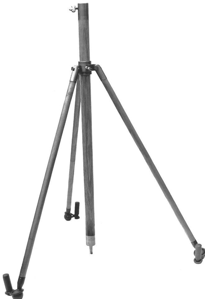
B: Das Stativ mit der zentralen, senkrechten Säule und den drei Streben, welche die Säule in ihrer Stellung fixieren.
