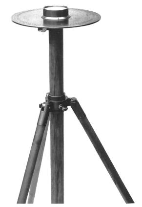
D: Die Mess-Schyben mit aufgesetzter Bussole.
