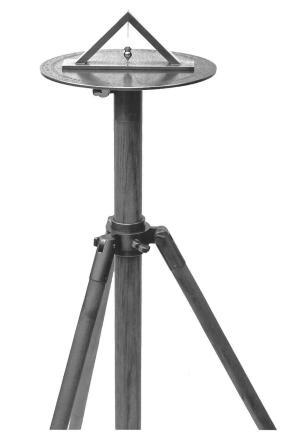
C: Das Horizontieren der Mess-Schyben mittels der Blywag (Bleiwaage, auch Setzwaage genannt).
