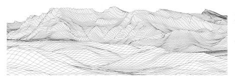
Abb. 14: Der Einfluss von Erdkrümmung und Refraktion anhand eines Blicks von Aarburg Richtung Pilatus. Wäre die Erde eben und gäbe es keine Refraktion, so würde sich der Titlis (Bildmitte) deutlich über das Tomlishorn erheben.
