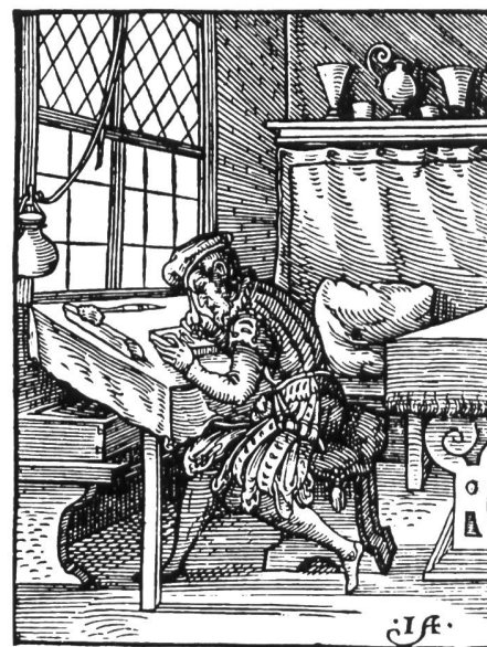
Abb. 17: Der Formschneider führte, aufgrund der Vorzeichnung durch den Reisser, den eigentlichen Holzschnitt aus. Dieser diente direkt als Druckträger. Holzschnitt von Jost Amman, Frankfurt 1568.
