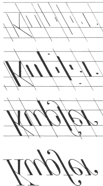
Abb. 15: Der Arbeitsablauf des Schriftstiches. (Zeichnung A. Oberli).
