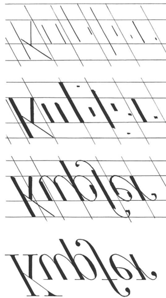
Abb. 15: Der Arbeitsablauf des Schriftstiches. (Zeichnung A. Oberli).
