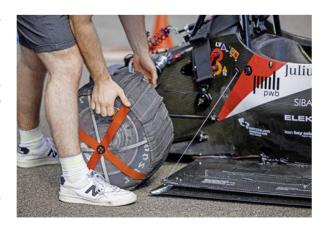
EN HAUT: Montage des pneus tempérés. On aperçoit le dispositif d'aspiration sous la voiture.
