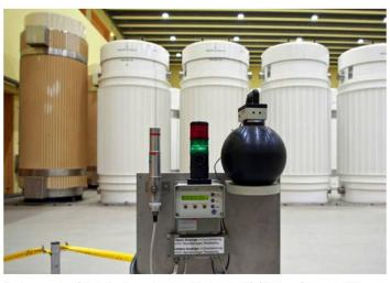
Conteneurs de déchets hautement radioactifs dans le dépôt intermédiaire de Würenlingen, avec appareils de mesure de surveillance au premier plan. Photo Keystone
