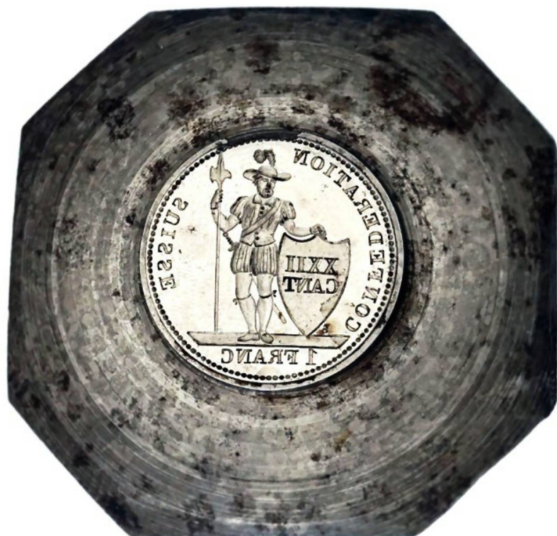
Un coin pour la frappe au balancier de la monnaie de 1 franc à l'écu. Canton de Vaud, Lausanne, 1846.
