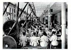
Kemptthal, 1896: travail à la chaîne dans l'usine Maggi. Avant l'électrification, le tapis roulant dédié à l'emballage était entraîné par des installations de transmission mécaniques
