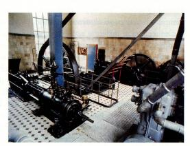
Uster, 1980: cuves de brassage de la brasserie d'Uster, avec la dernière machine à vapeur de l'Oberland zurichois. La machine de ventilation et un compresseur de refroidissement datent de 1897.
