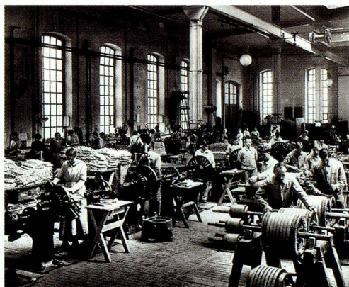
1915. Usine BBC de Münchenstein. Fabrication des bobines employées dans les moteurs des locomotives.
