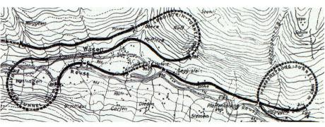
Les sept tunnels hélicoïdaux du chemin de fer du Gothard, véritable œuvre d'art.
