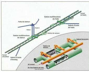
Schéma du tunnel de base du Gothard, avec ses aires d'arrêt d'urgence et son système d'aération.
