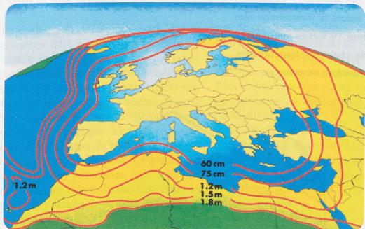
La réception des signaux transmis par le satellite Hotbird 3 requiert une antenne parabolique appropriée ayant au moins 60 centimètres de diamètre et munie d'un LNB (convertisseur) universel. La carte vous fournira toutes les indications nécessaires sur la diamètre de l'antenne parabolique correspondant à la zone de desserte où vous résidez.
