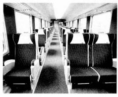
Les parties latérales et frontales ont des couleurs différentes et sont reliées par un moyen mécanique. Qu'il s'agisse du siège ou de la paroi, le principe est toujours le même: la construction et le système de fixation mécanique doivent être apparents.
