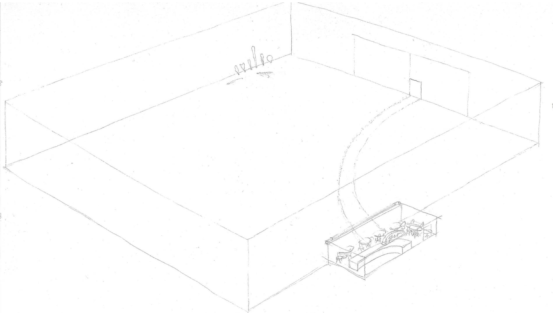
Die Bar ist eine Blechbaracke, die nachträglich an eine Seitenwand einer Lagerhalle gebaut wurde. Die beiden Räume sind untereinander über die gesamte Kontaktfläche verbunden. Anstelle einer festen Barwackenrückwand dient ein Rollladen, der auf der
