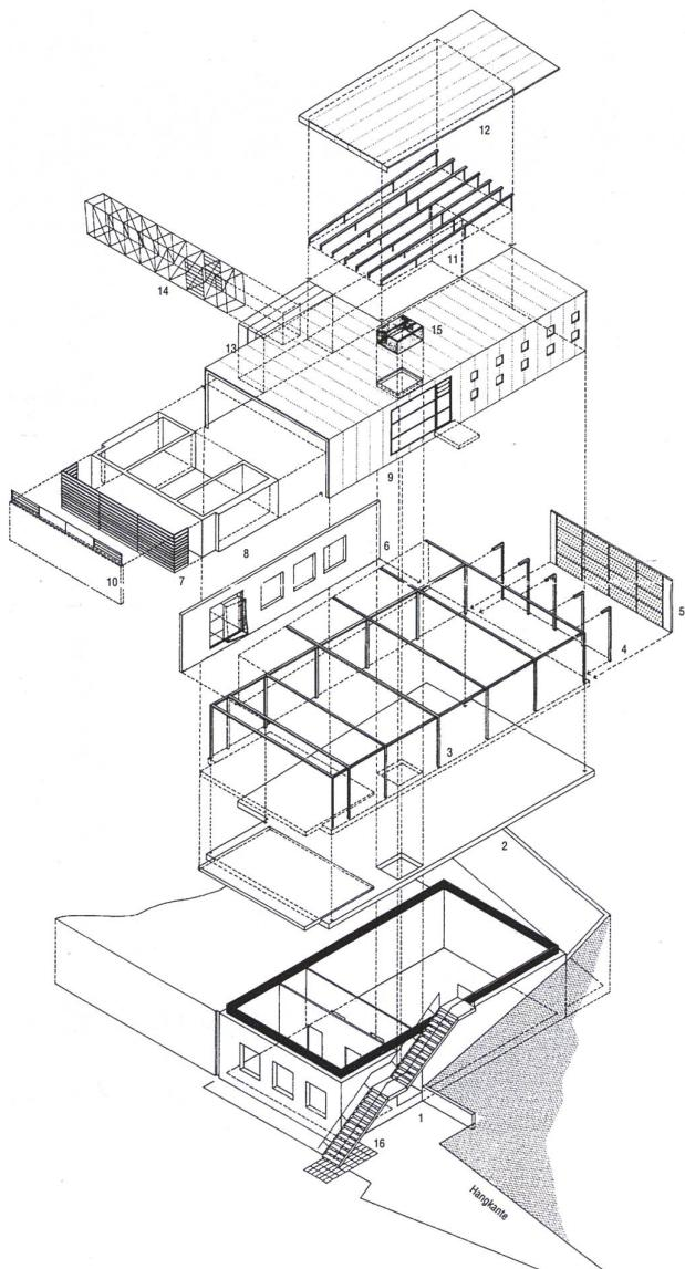
Da die bestehende Gebäudestruktur keine Aufstockung im Bereich des eingeschossigen Flachbaus zuließ, war es notwendig, die Lastabtragung über neu zu errichtende konstruktive Elemente, hier Betonscheiben, zu ermöglichen.
