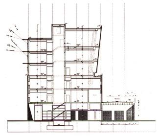
bracht. Die Erschließung besteht aus zwei Aufzügen, einem innenliegenden Treppenhaus und zwei an beiden Enden außen liegenden Treppenhäusern.
