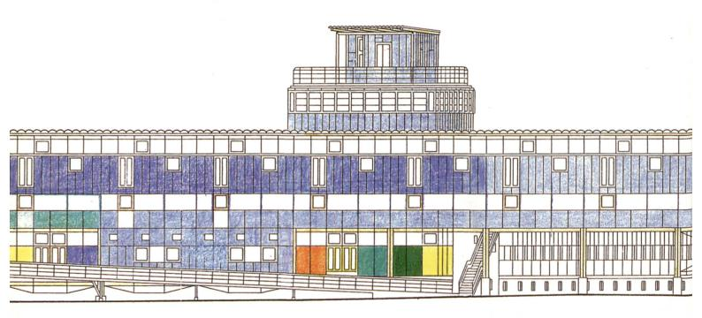
ges Holzskelettbauwerk (2. BA viergeschossig) an dem Massivbau. Bestimmendes Element ist ein geschoßhoher Träger im 1. OG in Längsrichtung. Er lenkt das 2,40 m-Raster aus Dach und dem 2. OG in ein 7,20 m-Raster um und ermöglicht somit im Erdgeschoß bzw. Brückenbereich (zwischen den jeweiligen Quartieren) Flexibilität und Transparenz.
