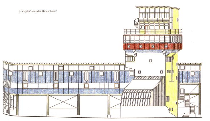
Die äußerste Schicht der Fassaden besteht aus zementgebundenen Spanplatten, deren Elementstöße Holzleisten überdecken. Innen kamen leinölbehandelte Seelieferschichtplatten zur Anwendung.
