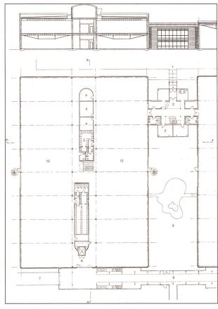
Schnitt und Grundriß des Hallentyps 1, Elektronikmontage
