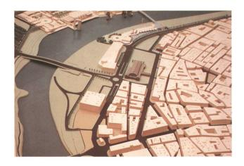
Folge der Rekultivierung des Ufers: durch den Ausbau der Trassenführung östlich von Altstadt und el Erenal kann der neue Hauptbahnhof Santa Justa entstehen, während die Trasse von hier aus ein großes Stück untertunnelt geführt werden kann; Santa Justa markiert mit seinen Gleisund Hallenniveaus den Übergang von der Untertunnelung zur Offenlage der Trasse: deshalb sind Vorfahrt und Eingangsbereich frei von störenden Böschungen.
