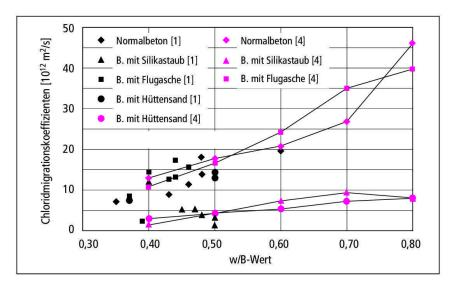
Abb. 1 Chloridmigrationskoeffizienten in Abhängigkeit von Wasserbindemittelwerten; Daten von TFB [1] und [4] (Laborbetone und Betone von Drittprojekten im Alter von 28 Tagen).
