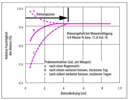
Abb. 3 Einfluss der Umgebung auf den Wassergehalt einer Mole in Helgoland (ermittelt an Bohrkernen), nach [5].
