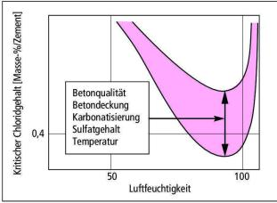
Abb. 2 Einflüsse auf den kritischen Chloridgehalt für die chloridinduzierte Korrosion (nach [3]).
