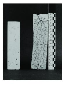
Sulfatbeständigkeit von Mörtelprismen aus Portlandzement mit hohem Sulfatwiderstand (links) bzw. Portlandzement (rechts): Nach längerer Lagerung in einer Lösung mit einem hohen Sulfatgehalt treten nur beim Prisma aus Portlandzement Schäden auf.
