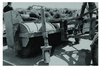
Abb. 9 Detail des zur Bürstmaschine umgebauten Graders, mit dem die lärmmindernde Oberfläche hergestellt wird.
