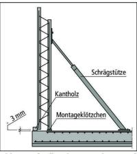
Abb. 6 Aufstellen der Fertigplatten auf einer Fundamentplatte zum Ausbetonieren mit Ortbeton (nach [12, 13]).
