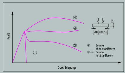
Biegezugversuche an Stahlfaserbetonen (nach [9], modifiziert).
