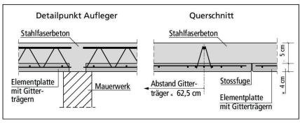
Abb. 3 Prinzip der Elementdecken ohne obere Bewehrung, dargestellt an einem Zwischenauflager auf Mauerwerk (nach [6]).
