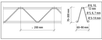
Abb. 2 Gitterträger zur Bewehrung von Elementdecken (nach [5]). Zeichnungen: TFB
