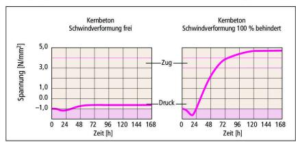
Abb. 4 Zeitliche Entwicklung der Spannung im Kern einer 400 mm dicken Betonplatte: Während der Erwärmung in den ersten Stunden treten Druck-, während der Abkühlung Zugspannungen auf (nach [2]).
