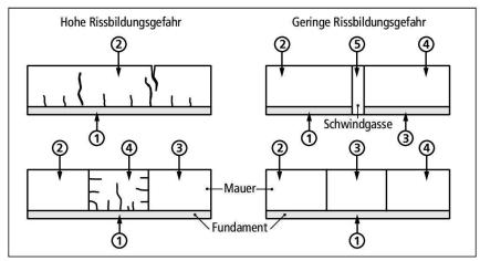
Abb. 7 Die Reihenfolge der einzelnen Betonieretappen ( $\mathfrak{D} \to \mathfrak{S}$ ) hat einen grossen Einfluss auf das Auftreten von Schwindrissen. (nach [23]).
