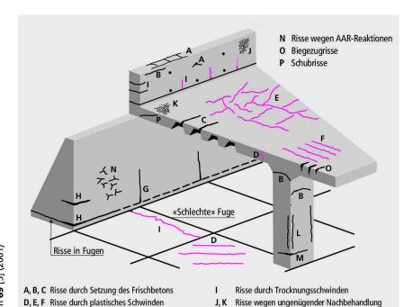
Abb. 3 Schwindrisse (D, E, F, I) sind nur eine Art von Rissen, die in Betonbauteilen in Abhängigkeit von Faktoren wie der baulichen Konzeption, der Herstellung und der Beanspruchung auftreten können (nach [19].)
