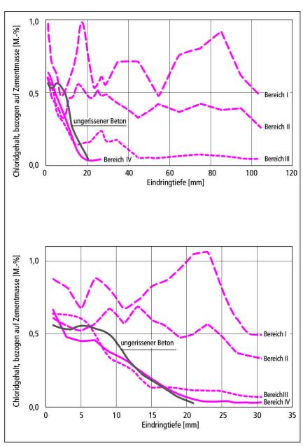
Abb. 4 Gesamtchloridgehalt in Funktion von der Eindringtiefe und vom seitlichen Abstand von den Rissflanken eines Betons (W/Z = 0,50) mit 0,1 mm Rissweite (oben) bzw. 0,4 mm Rissweite (unten) nach 24 Std. Aufsaugen einer 3-M.-%igen Natrium-chloridlösung (nach [20]). (Seitlicher Abstand von den Rissflanken: Bereich I = 0-5 mm, Bereich II = 5-10 mm, Bereich III = 10-20 mm, Bereich IV = > 20 mm.)
