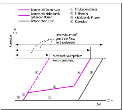
Abb. 5 Modelle zum zeitlichen Verlauf der Korrosion in Betonen mit Trennrissen, mit nicht durchgehenden Rissen sowie ohne Risse (nach [21, 22]).
