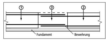
Abb. 8 Schwindgassen (③) sind ein wirkungsvolles Mittel gegen Trocknungsschwindrisse, wenn sie genügend lange frei gelassen werden (nach [23]).
