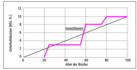
Abb. 11 Unterhaltskosten einer 10 Mio. Fr. teuren Brücke mit einer Nutzungsdauer von 100 Jahren (nach [1]).
