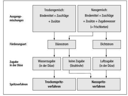
Abb. 2 Verfahrenstechniken beim Spritzbeton (nach [5], leicht modifiziert).
