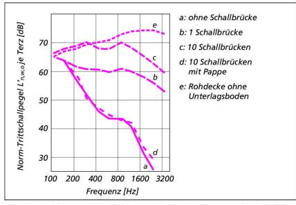
Abb. 6 Auswirkung von Schallbrücken auf die Trittschalldämmung (nach [3, 14]).
