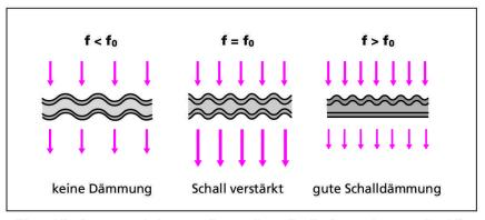
Abb. 5 Schwingungsverhalten massiver Decken mit schwimmenden Unterlagsböden (nach [3]).
