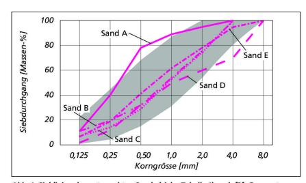
Abb. 1 Sieblinien der untersuchten Sande (siehe Tabelle 1) nach [2]. Grau unterlegt: Sieblinienbereich für Rund- und Mischsande 0/4 mm nach VSS [7].
