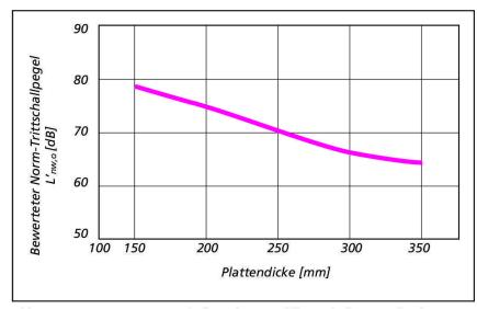
Abb. 4 Bewerteter Norm-Trittschallpegel von Stahlbetondecken verschiedener Dicke (nach [13]).
